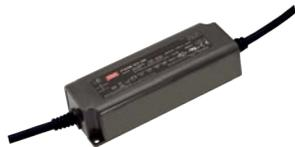
Alimentation basse puissance de classe II dans un boîtier en plastique IP67 90~264VCA/24VDC. Protection contre les courts-circuits, les surcharges et les surtensions.
