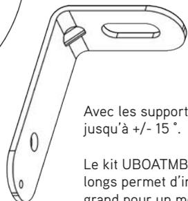
Avec les supports fournis, l'appareil peut être orienté jusqu'à +/- 15°.
