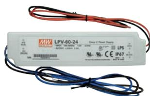
Alimentation led de classe II avec correction du facteur de puissance dans un boîtier plastique IP67 90~264 VCA/24VDC. Protection contre les courts-circuits, les surcharges et les surtensions. Câbles de raccordement pré-assemblés de 30cm. Rendement de  $\pm 88\%$ .
