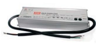
Alimentation led de classe II avec correction du facteur de puissance dans un boîtier métallique IP65 90~264VCA/24VDC. Protection contre les courts-circuits, les surcharges et les surtensions. Câbles de raccordement pré-assemblés de 30cm. Rendement de  $\pm 90\%$ .
