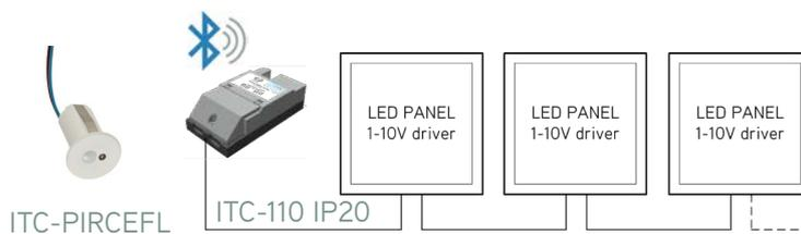
Combiner le capteur intégré ITC-PIR230 avec une interface ITC-110 pour gérer une ligne de panneaux LED avec de la détection de mouvement et/ou niveau de flux lumineux.
